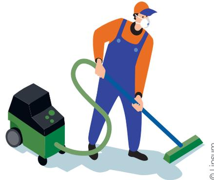
▲ Opération de nettoyage à l'aide d'un aspirateur de classe M.
