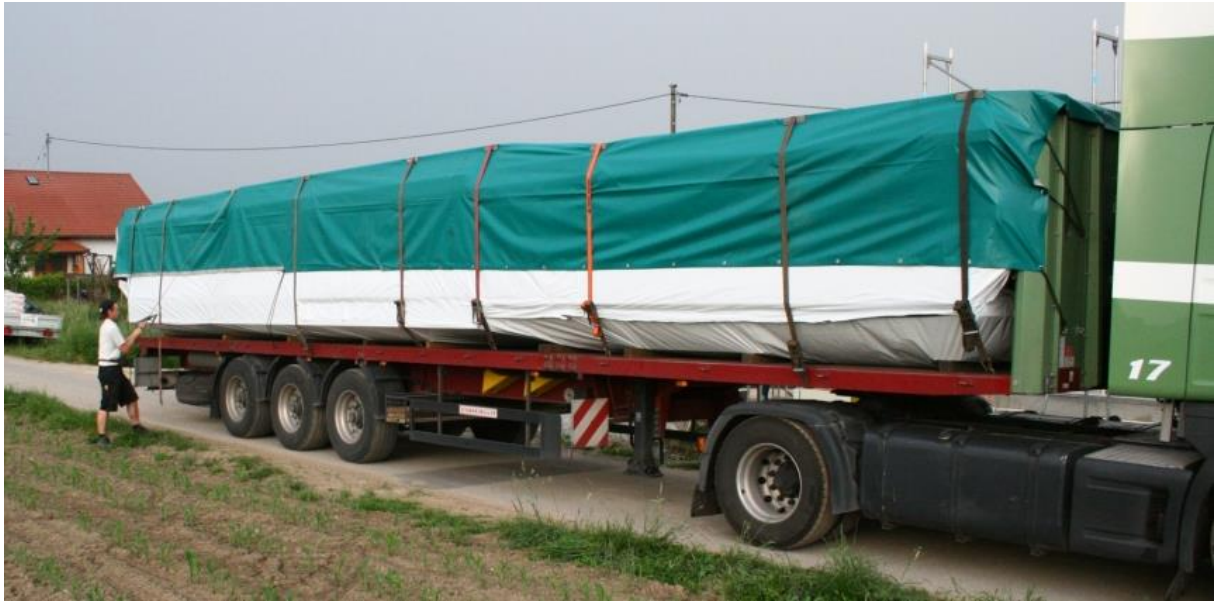
Figure 21 : Photo d'un transport de panneaux CLT protégés des intempéries (Source Stora Enso)
