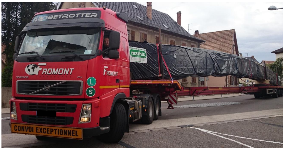
Figure 20 - Photo d'un transport de poutre en bois lamellé collé protégée des intempéries (Source MATHIS)
