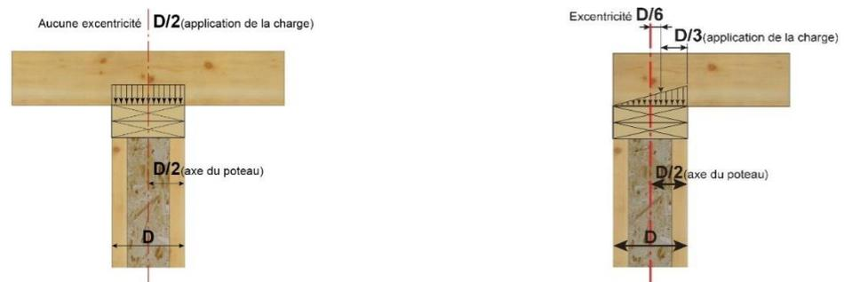
Figure 37 Montant soumis à chargement centré (gauche) ou chargement excentré (droite)
