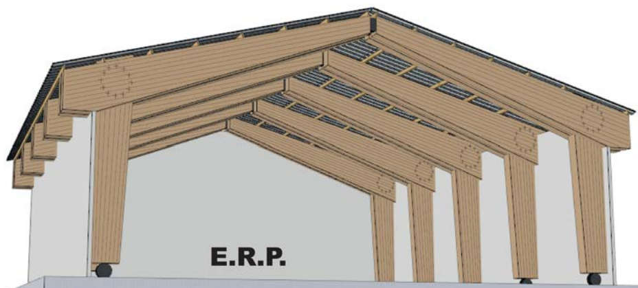
Figure 7 : Bâtiment ERP en structure bois ou lamellé-collé
