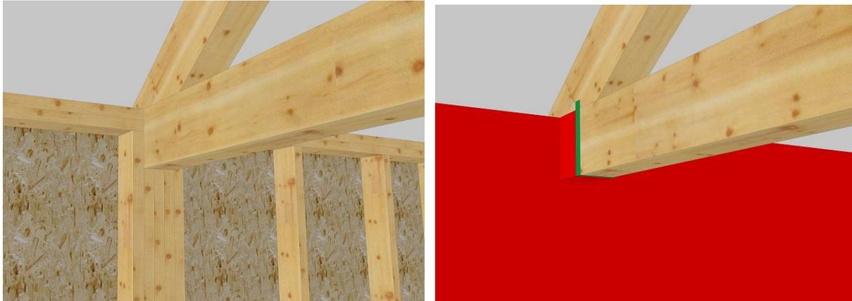
Figure 65 Illustration de la liaison entre paroi verticale et pied de ferme traditionnelle
