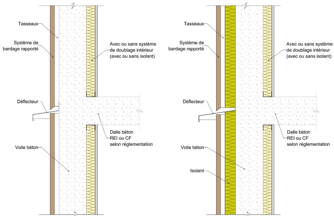
Figure 43 : Bardage ventilé avec revêtement extérieur à base de bois sur support en maçonnerie.
