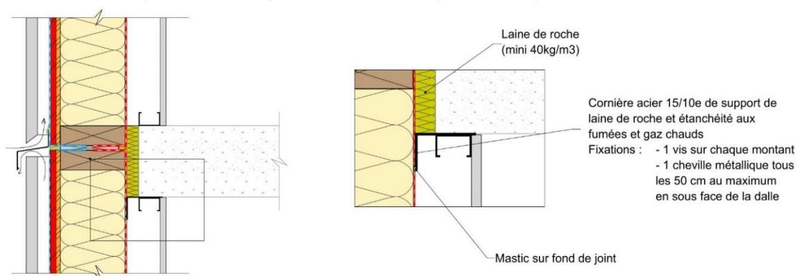
**Figure 2:** Traitement de l'étanchéité au nez de dalle béton
