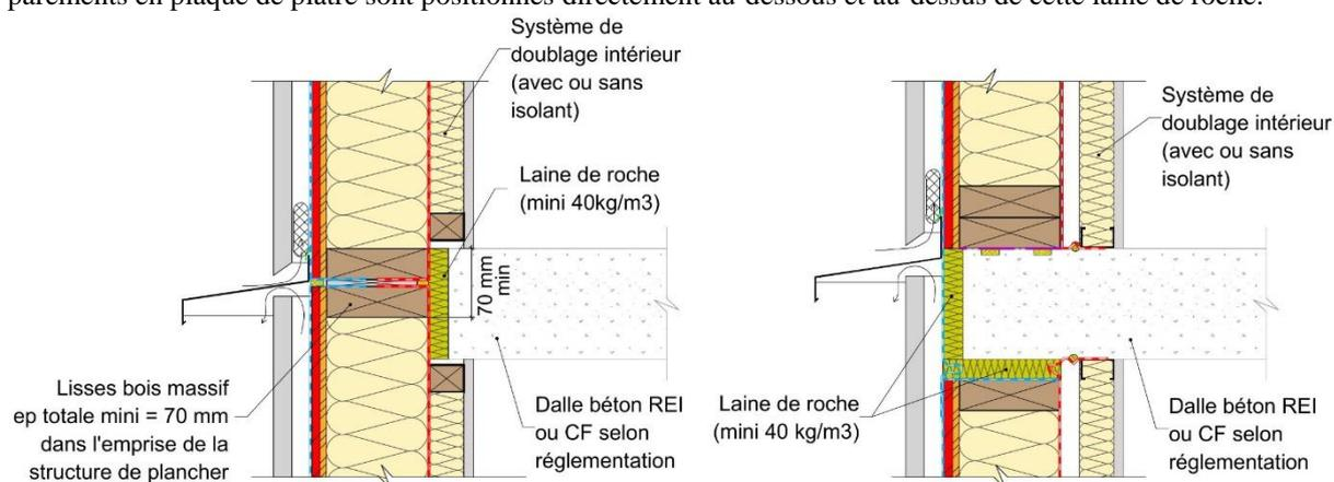
**Figure 1:** Traitement de l'étanchéité au nez de dalle béton
