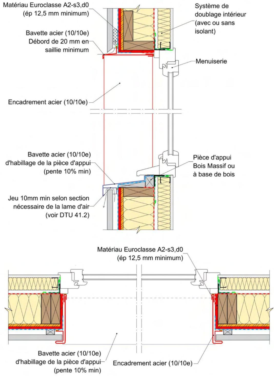
**Figure 6:** Traitement des baies - menuiseries en applique intérieure avec un matériau A2-s3, d0 + encadrement acier.
