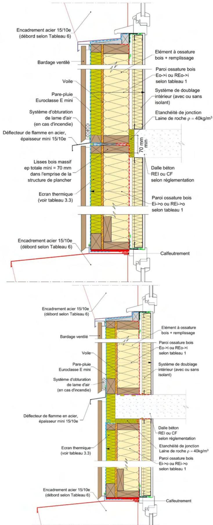
Figure 34 : Façade/mur ossature bois et plancher en béton.
