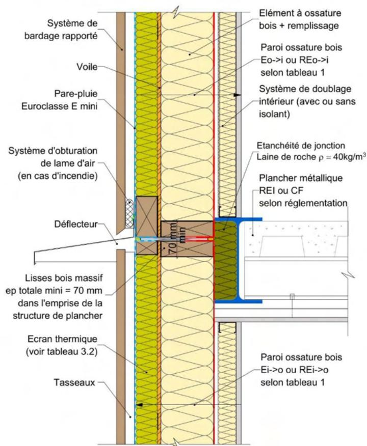
Figure 33 : Façade/mur ossature bois et plancher métallique.
