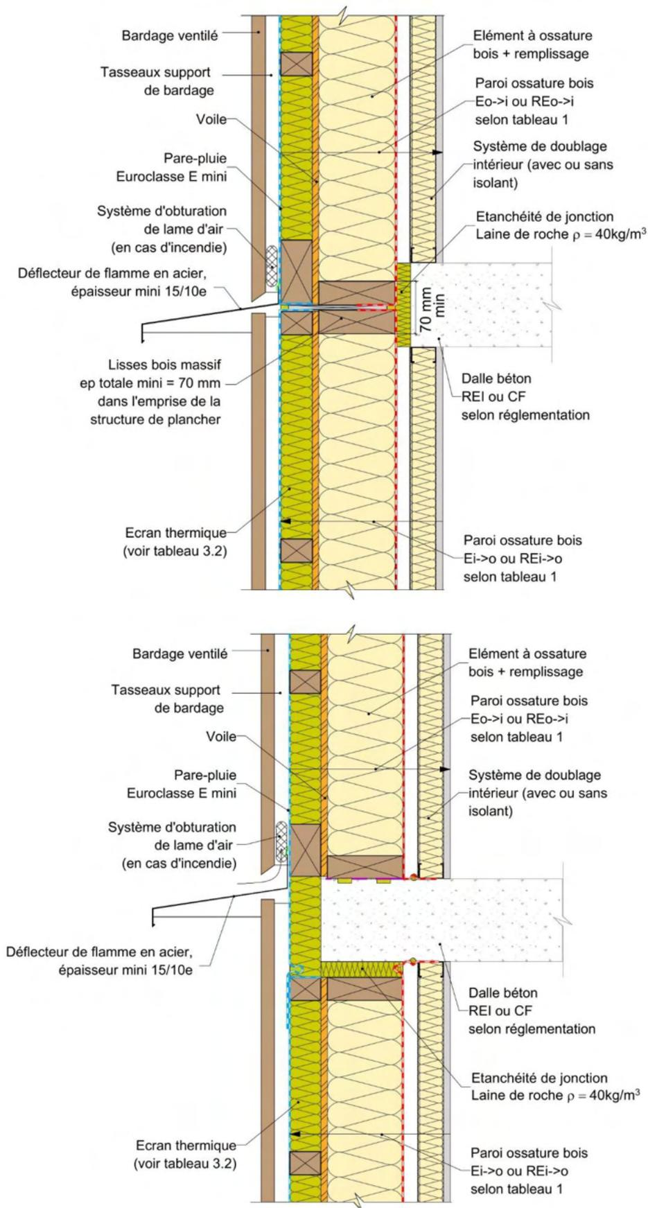
Figure 29 : Façade/mur ossature bois et plancher béton.
