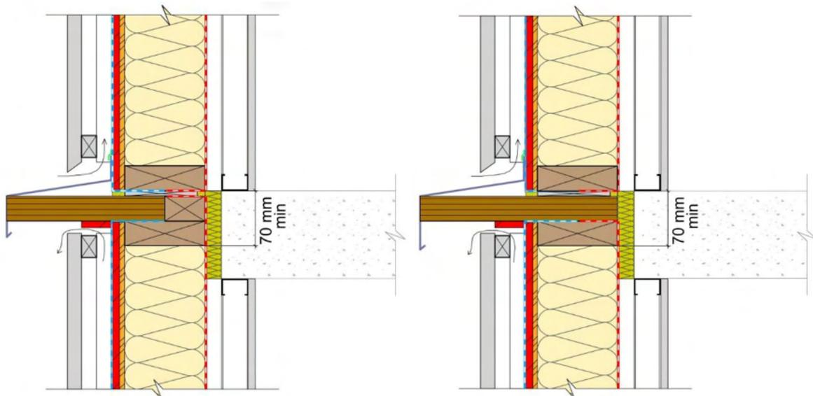
Figure 18 : Principe de configuration du déflecteur renforcé
