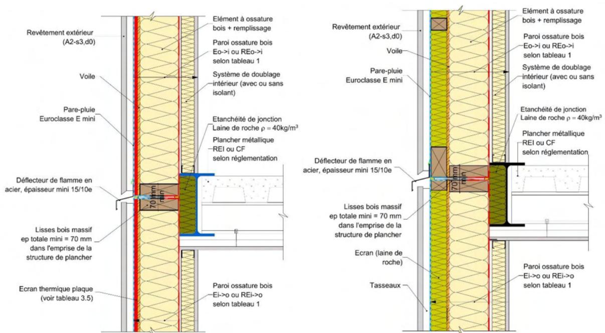
Figure 42 : Façade/mur en ossature bois et plancher métallique.
