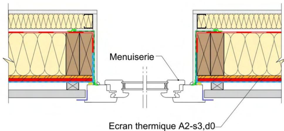
Figure 8: Traitement des baies - menuiseries en applique extérieure avec un matériau A2-s3, d0.
