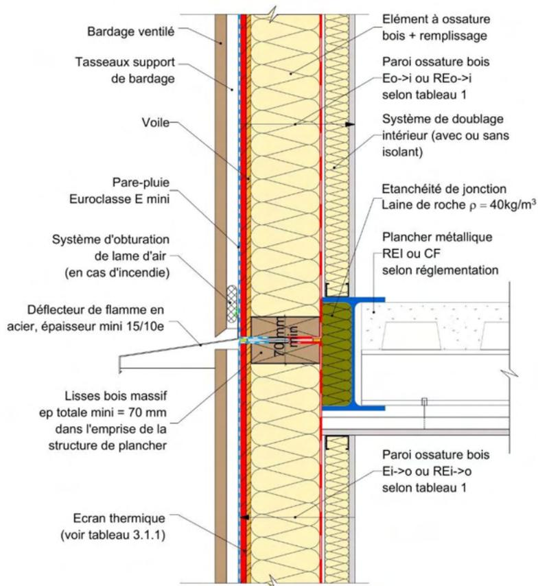
Figure 26 : Façade/mur ossature bois et plancher métallique.
