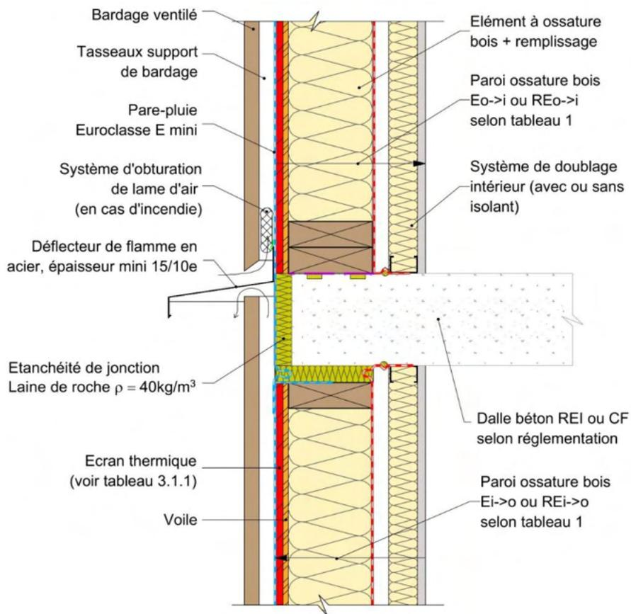
Figure 22 : Façade en ossature bois sur plancher béton.
